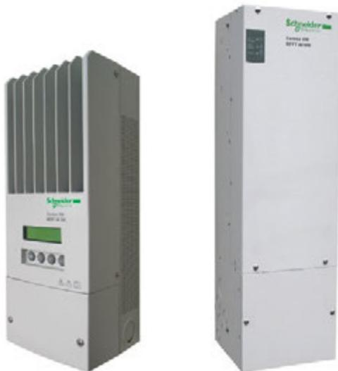
Estos reguladores de carga solar Schneider Electric XW son controladores fotovoltaicos que rastrean el punto de potencia eléctrica máxima de un campo FV con el fin de cargar las baterías mediante la máxima intensidad disponible. Durante la carga los XW SCC regulan la tensión e intensidad de salida de las baterías basándose en la cantidad de energía disponible proveniente del campo FV y el nivel de carga de las baterías.
