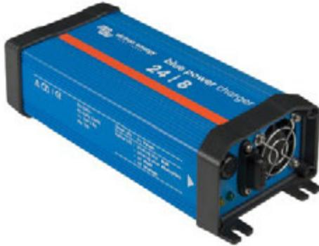
El modo de almacenamiento se activa cuando la batería no ha sufrido ninguna descarga en 24 horas. En el modo de almacenamiento, la tensión de flotación se reduce a 2,2 V/acumulador (13,2 V para baterías de 12 V) para reducir el burbujeo y la corrosión de las placas positivas. Una vez a la semana, se vuelve a subir la tensión a nivel de absorción para "igualar" la batería. Esta función evita la estratificación del electrolito y la sulfatación, las causas principales de los fallos en las baterías
